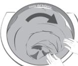
**Prendas Voluminosas:** Para lavar sus prendas voluminosas correctamente se sugiere un acomodo especial. Se toma de uno de los extremos y se introduce en forma de espiral, procurando que quede acomodada la prenda alrededor de la canasta, así hasta finalizar en el otro extremo. Si las prendas sobrepasan el límite señalado, debes comprimir ligeramente hacia adentro, asegurándose que el volumen quede por abajo del límite. Ver figura.
