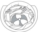
**Empieza a lavar:** Coloque la carga de ropa de manera uniforme, alrededor del infusor (de preferencia no sobre éste) para que la carga quede uniformemente distribuida. La lavadora inicia el ciclo de lavado girando la canasta para acomodar la carga para un mejor desarrollo del ciclo.
