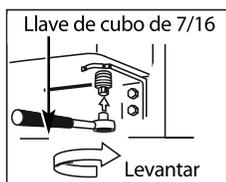
1. Usando una llave de 7/16, gire el tornillo de ajuste de la puerta hacia la derecha para elevar la puerta; gírelo hacia la izquierda para hacerla descender. (Un tapón de nylon está encajado en la rosca del pin para impedir que el pin gire a menos de que se use una llave.)
