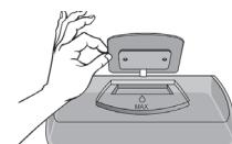
4 Cierre la tapa, coloque el tanque en su posición inicial y asegúrese de empujarlo hasta el fondo. El agua se verterá en la heladera.
