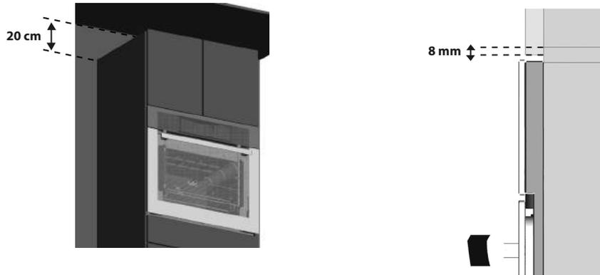
**IMPORTANTE:** Usted notará que el gabinete debe tener además un hueco en el panel superior para proporcionar al horno de empotre una adecuada ventilación. Es muy importante no obstruir con ningún objeto la ventilación superior, deje un claro mínimo de 20 cm entre la parte superior del gabinete y el techo de la cocina.
