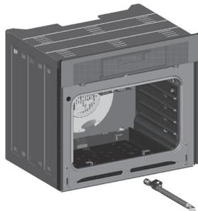
8. Si la unidad está equipada con asador a gas, remueva la esprea del quemador del asador marcada con 0.039 y reemplácela por la esprea calibrada para Gas Natural marcada con 0.054
