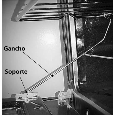
Los ganchos deben de estar ensamblados a los soportes de la puerta.
